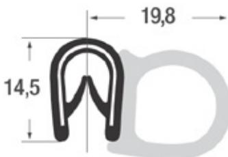
Flexibles Kantenschutzdichtprofil Kantenschutz PVC mit eingebettetem Stahlklemmband und seitlich aufgesiegeltem Moosgummi Dichtschlauch EPDM, Klemmbereich 1.0–4.0 mm
