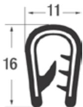
Flexibles PVC Kantenschutzprofil mit eingebettetem Stahlklemmband, Klemmbereich 4.0–6.0 mm
