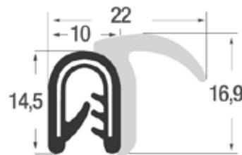
Flexibles Kantenschutzdichtprofil Kantenschutz PVC mit eingebettetem Stahlklemmband und oben aufgesiegeltem Moosgummi Dichtschlauch EPDM, Klemmbereich 1.0–4.0 mm
