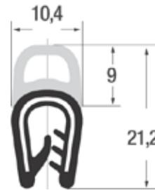
Flexibles PVC Kantenschutzprofil Kantenschutz PVC mit eingebettetem Stahlklemmband und oben aufgesiegeltem Moosgummi Dichtschlauch EPDM, Klemmbereich 1.0–4.0 mm
