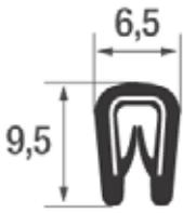
Flexibles PVC Kantenschutzprofil mit eingebettetem Stahlklemmband, Klemmbereich 1.0–2.0 mm
